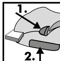
Придържайте винаги машината с две ръце. Натиснете бутона на блокировката срещу включване (1).
