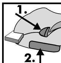
De machine steeds met uw beide handen vasthouden. De knop ter beveiliging tegen onbedoeld inschakelen indrukken (1). De AAN/UIT-schakelaar (2) indrukken.
