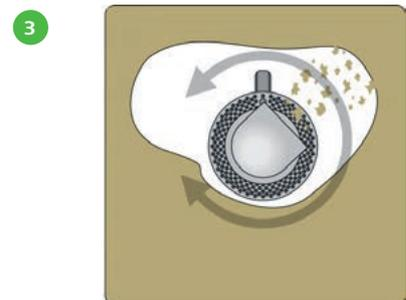
Jetzt dreht man den Düsenauslass nacheinander in Richtung der beiden Elementecken. So wird eine optimale Verdichtung im oberen Bereich erzielt.
