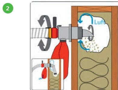
...bis der Bereich des Düsenauslasses erreicht wird. Dies ist durch das ansteigende Druckgeräusch erkennbar.
