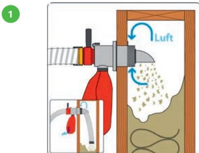
Die entlüftete Drehdüse wird in eine passgenaue Einblasöffnung gesetzt, die mit einer Lochsäge hergestellt wird. Das Element wird aufgefüllt...
