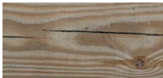
Spannungsrisse durch die Holz Trocknung
