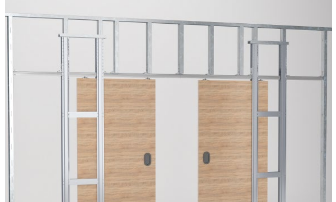
Bild 34: Sicherungslaschen entfernen und Anschlusswinkel befestigen
