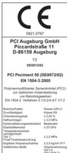
Betonersatz des PCI Peciment-II-Systems für die Anwendungsfälle PCC I und PCC II der ZTV-ING.
