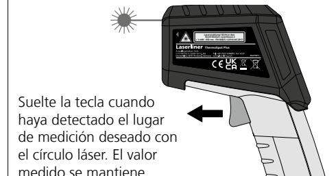
Suelte la tecla cuando haya detectado el lugar de medición deseado con el círculo láser. El valor medido se mantiene
