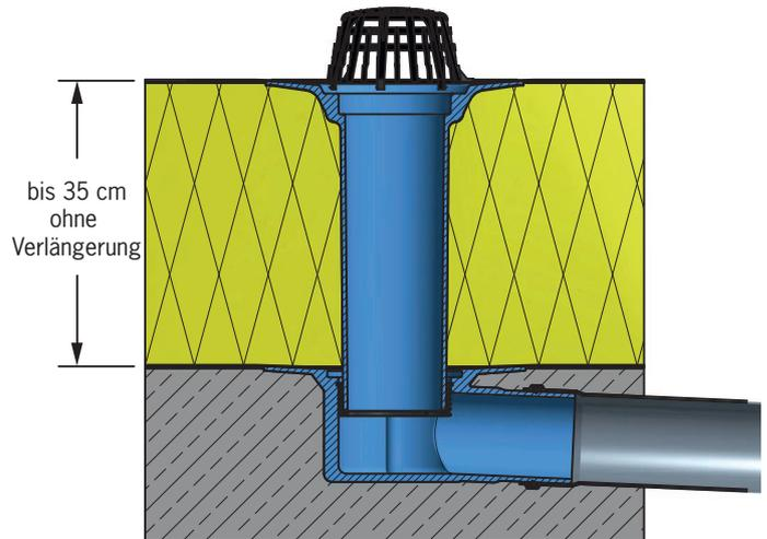
Kompakt-Kragen-Gully waagrecht DN 100 mit Aufstockelement im Warmdach
