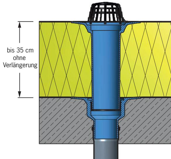
Kompakt-Kragen-Gully senkrecht DN 100 mit Aufstockelement im Warmdach
