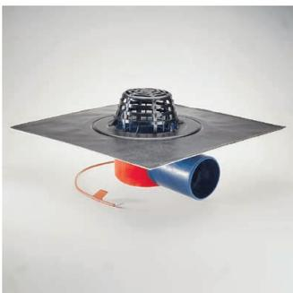
Der Kompakt-Kragen-Gully DN 70/DN 100/DN 125 ist sowohl in der senkrechten als auch in der waagerechten Ausführung als heizbarer Gully lieferbar. Beheizt wird mit einem integrierten, selbstregelnden 230-V-PTC-Heizelement. Das hält auch bei extremer Kälte eisfrei. Zur Schaltung der heizbaren Gullys bei Frostgefahr empfehlen wir die Verwendung des Frostschalter-Basissets (Art.-Nr. 5922, s. S. 57).
