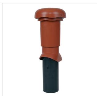
Die aerodynamisch optimierte Entlüftung des Venduct® Raumentlüfters durch Rohrgeometrie, Luftleitring und Regenhaube reduziert Verwirbelungen auf ein Minimum und stellt eine effektive Abluftleistung insbesondere bei ventilatorunterstützter Abluft sicher. Anfallendes Kondensat wird mittels einer Kondensattrinne sicher auf die Außenseite oberhalb der Dacheindeckung abgeführt.
