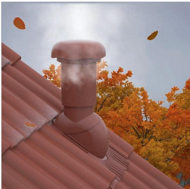
Die flexiblen Grundplatten in DN 100 passen sich durch die obere und untere Plissierung an die jeweilige Pfannenform an und fügen sich mit den formbaren seitlichen Passstreifen in die Deckung ein.
