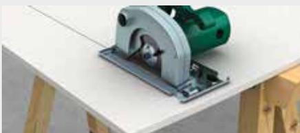
Sägen mit Handkreissäge
