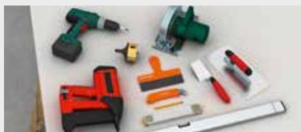
Werkzeuge zur Bearbeitung von **fermacell** Gipsfaser-Platten
