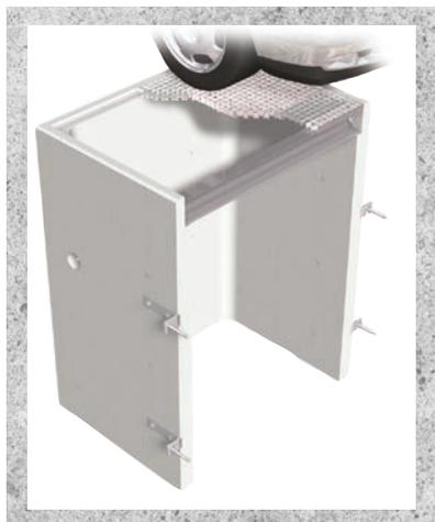
Je nach Anforderung sind die Schachtabdeckungen begehbar, Pkw- oder Lkw-befahrbar. Zur gleichmäßigen Aufnahme höherer Verkehrslasten der Rostabdeckungen stehen Stahlprofile zur Verfügung, die im oberen Bereich der Schachteile zusätzlich an der Gebäudewand verankert werden. Falls eine Wandmontage nicht möglich ist, werden Stahlprofile als tragende Traversen bereits im Werk in die Wandseite der Schachteile eingelassen.
