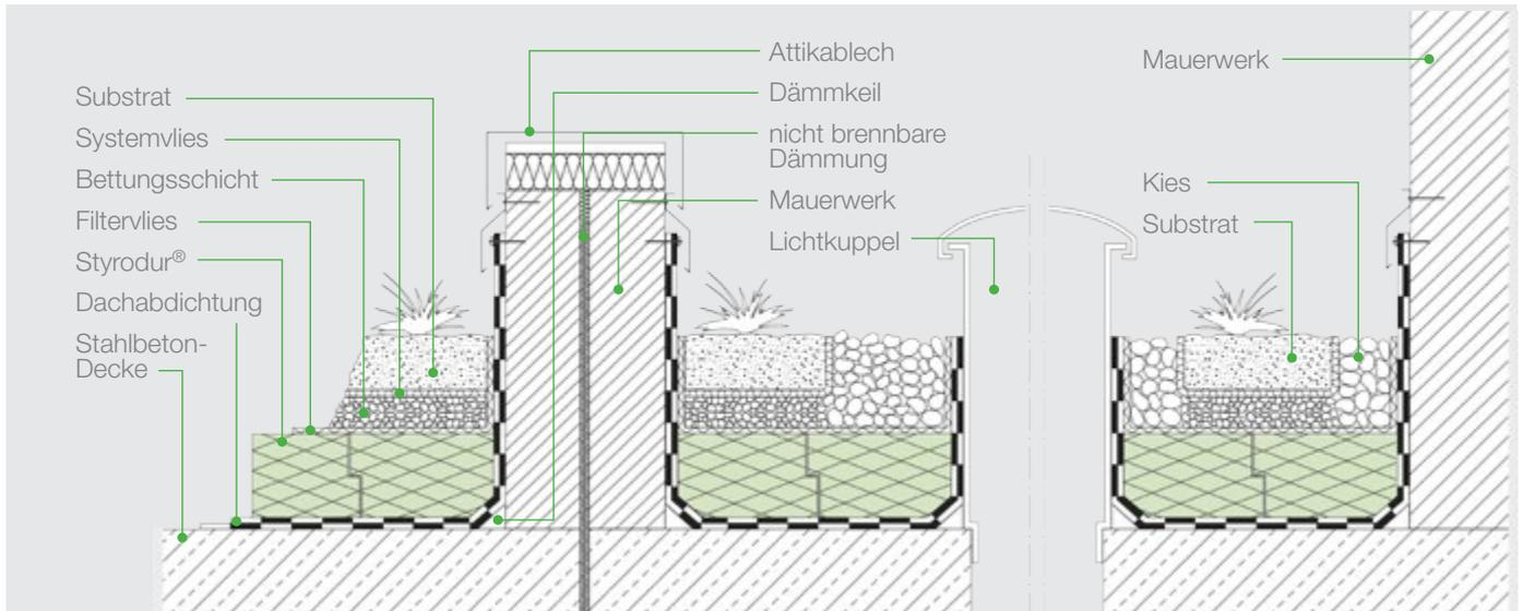
Abb. 36: Brandabschnitt eines Flachdaches mit Extensivbegrünung.
