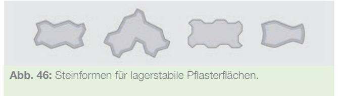
Abb. 46: Steinformen für lagerstabile Pflasterflächen.
