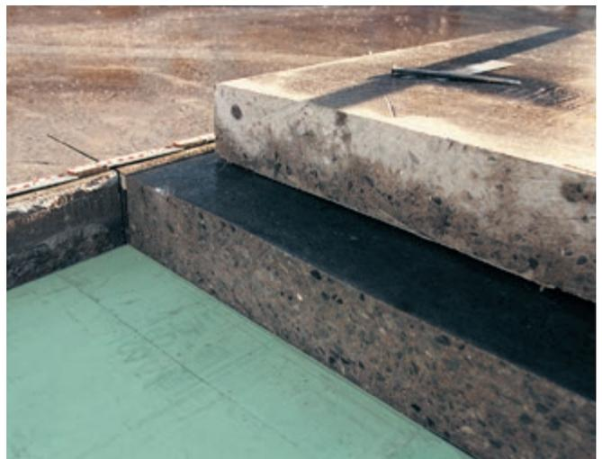
**Abb. 50:** Aufgeschnittene Ortbetonfahrbahnplatte zur wissenschaftlichen Untersuchung des Langzeitverhaltens.
