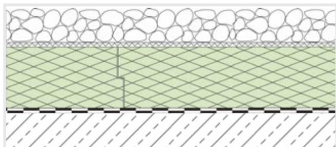
Abb. 10: Ausführung einlagig bekiestes Umkehrdach.
