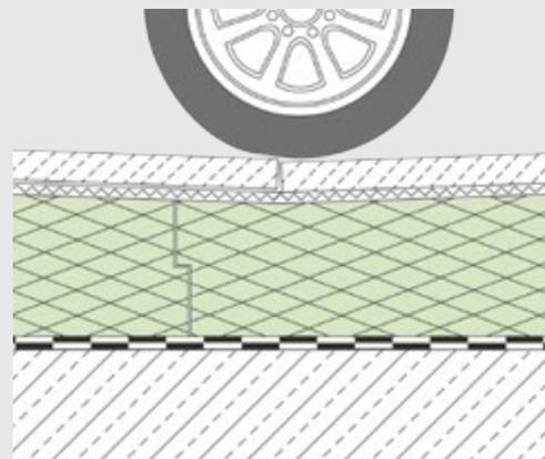
Beim UK-Dach liegt die Abdichtung unter der Dämmschicht geschützt.
