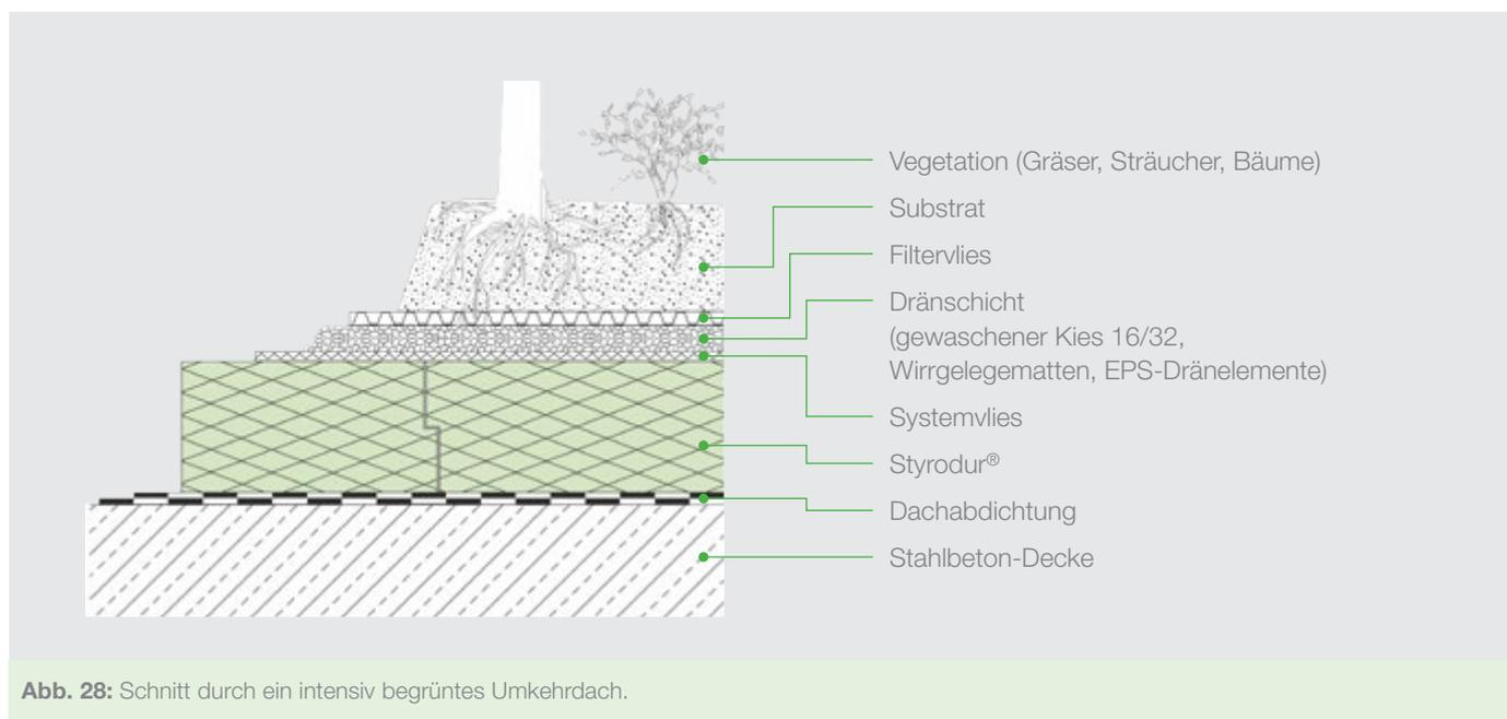
Abb. 28: Schnitt durch ein intensiv begrüntes Umkehrdach.
