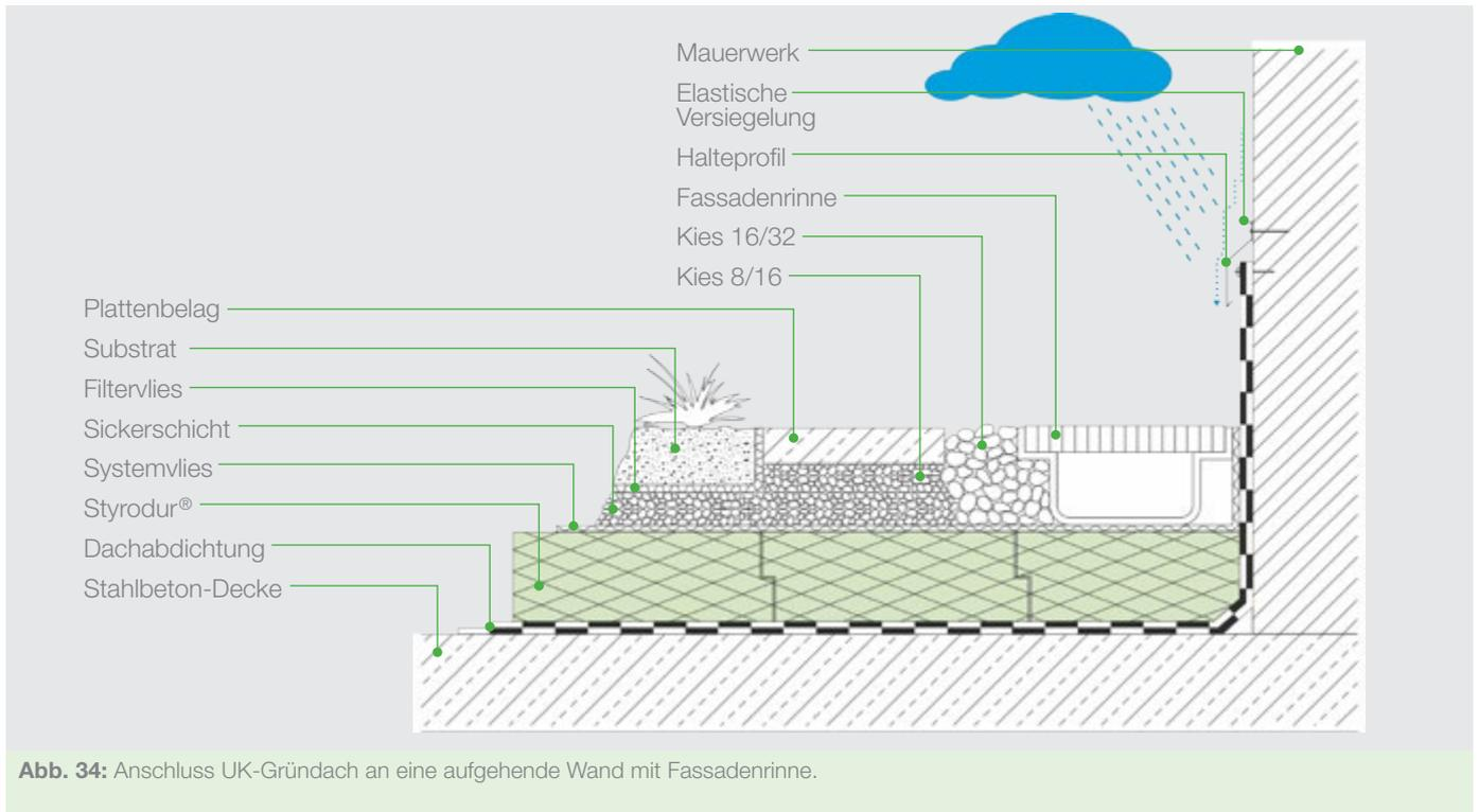
Abb. 34: Anschluss UK-Gründach an eine aufgehende Wand mit Fassadenrinne.
