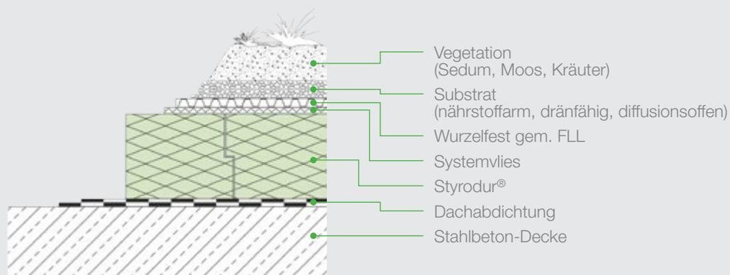
**Abb. 26:** Schnitt durch ein extensiv begrüntes Umkehrdach.
