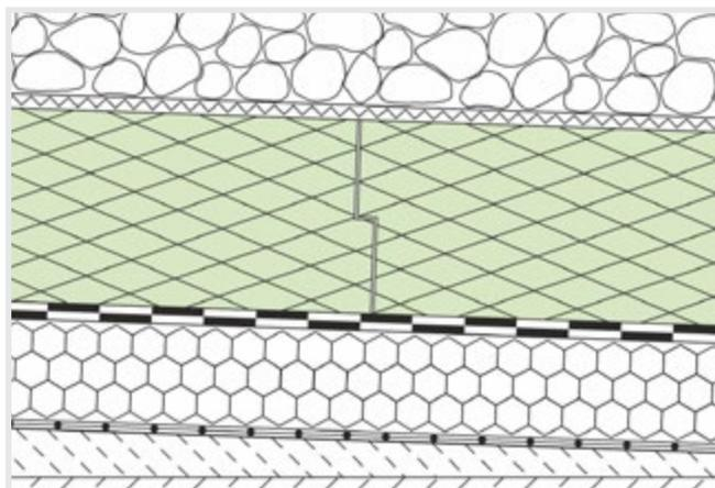
**Abb. 17:** Saniertes Plusdach mit Gefälledämmung im Altbestand.
