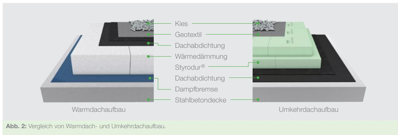
**Abb. 2:** Vergleich von Warmdach- und Umkehrdachaufbau.
