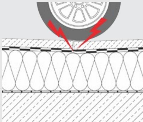
Beim konventionellen Warmdach wird die Abdichtung an den Fugen der Fahrbahnplatte besonders beansprucht.
