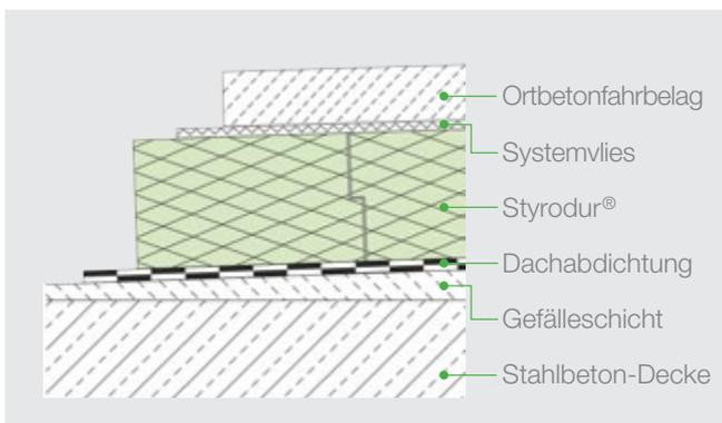
**Abb. 48:** Prinzipskizze eines Parkdaches mit Ortbetonfahrbelag auf einer Umkehrdachkonstruktion mit Styrodur®.
