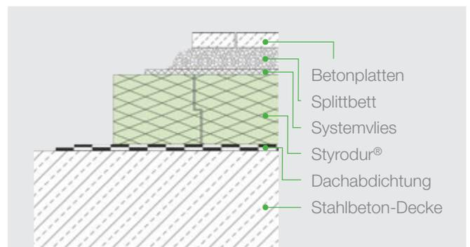
Abb. 38: Aufbau eines UK-Terrassendachs mit Betonplatten im Splittbett.
