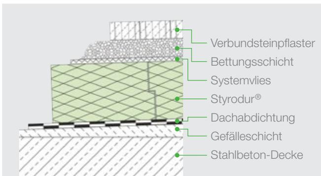
Abb. 44: Parkdachaufbau mit Verbundsteinpflaster auf einer Bettungsschicht.
