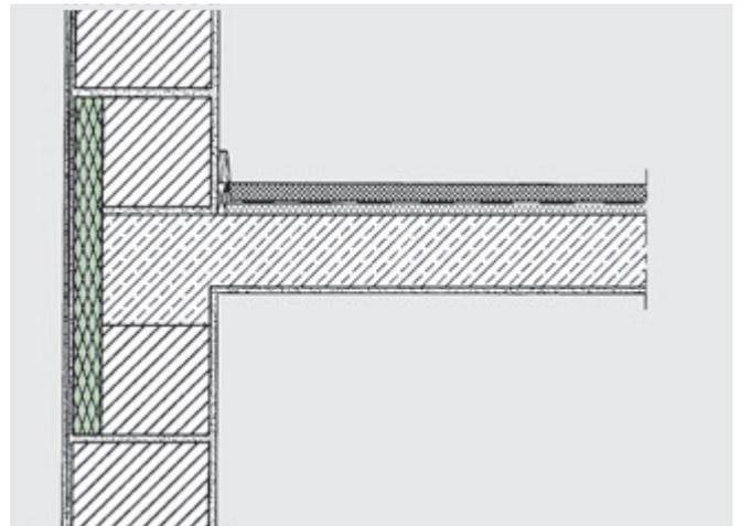
**Abb. 12:** Optimale Wärmebrückendämmung im Bereich des Deckenauflegers.
