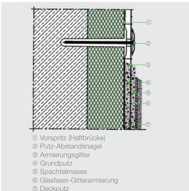
**Abb. 26:** Schnittdarstellung eines möglichen Putzaufbaus mit Putzträger bei großflächigen Styrodur®-Dämmungen.
