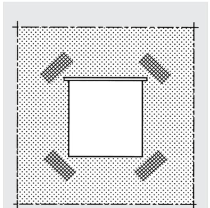
**Abb. 23:** Zusätzliche Diagonalbewehrung an Fensterecken.
