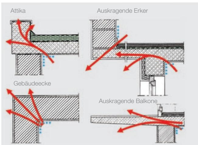
Abb. 3: Geometrisch bedingte Wärmebrücken.
