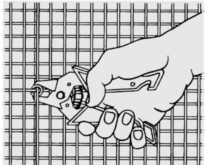
**Abb. 28:** Gitterüberlappungen werden mit Ringklammern im Abstand von 20 cm gegen Verschieben gesichert.
