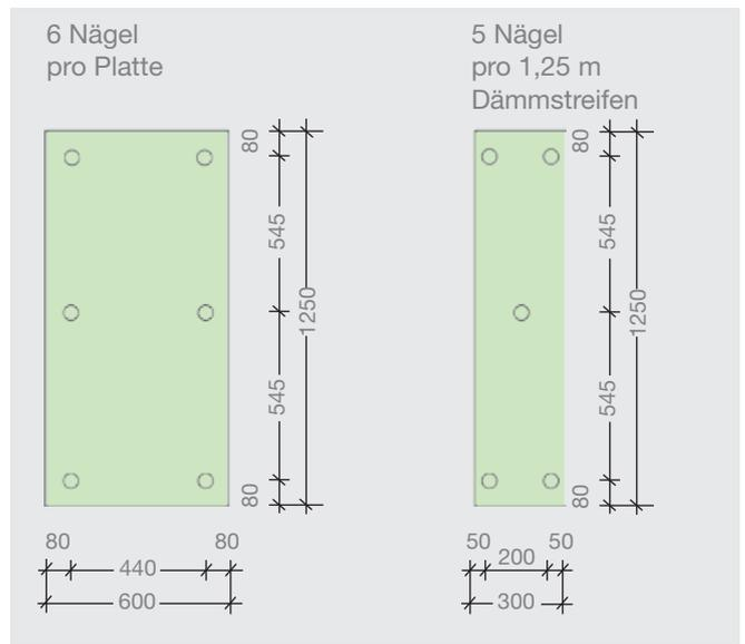
**Abb. 16:** Mögliche Anzahl und Anordnung von Kunststoffnägeln beim Einstellen von Styrodur® 2800 C-Platten in die Betonschalung (Maße in mm).
