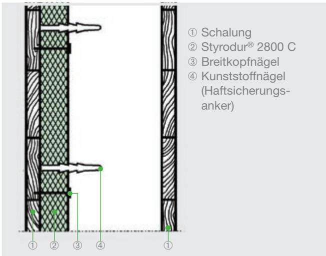
**Abb. 14:** Befestigen der Styrodur® 2800 C-Platten an der Holzschalung mit Breitkopfnägeln und Haftanker (Kunststoffnägel) zur Verankerung im Beton bei kritischen Fällen.
