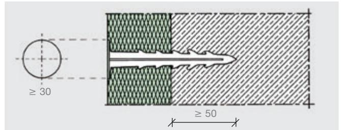
**Abb. 15:** Kunststoffnägel für die zusätzliche Verankerung von Styrodur® 2800 C (Maße in mm).
