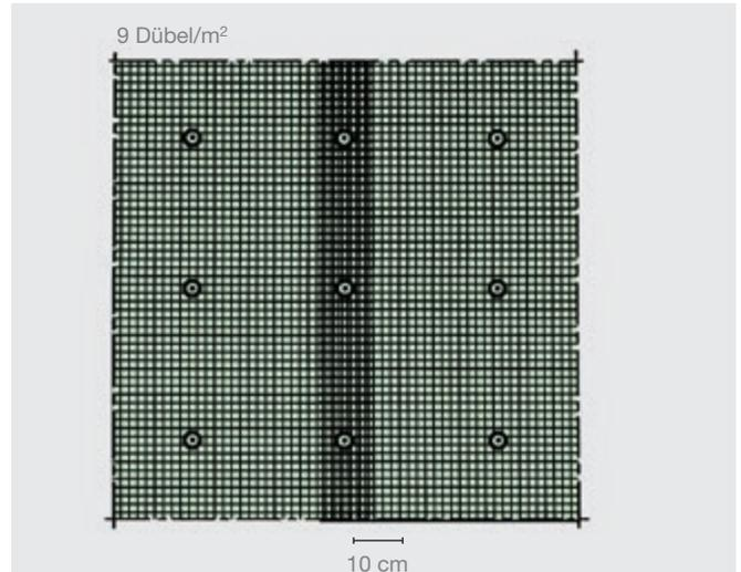
**Abb. 27:** Vollflächige Armierung mit einem Drahtgitter als Putzträger (9 Dübel pro m<sup>2</sup>).
