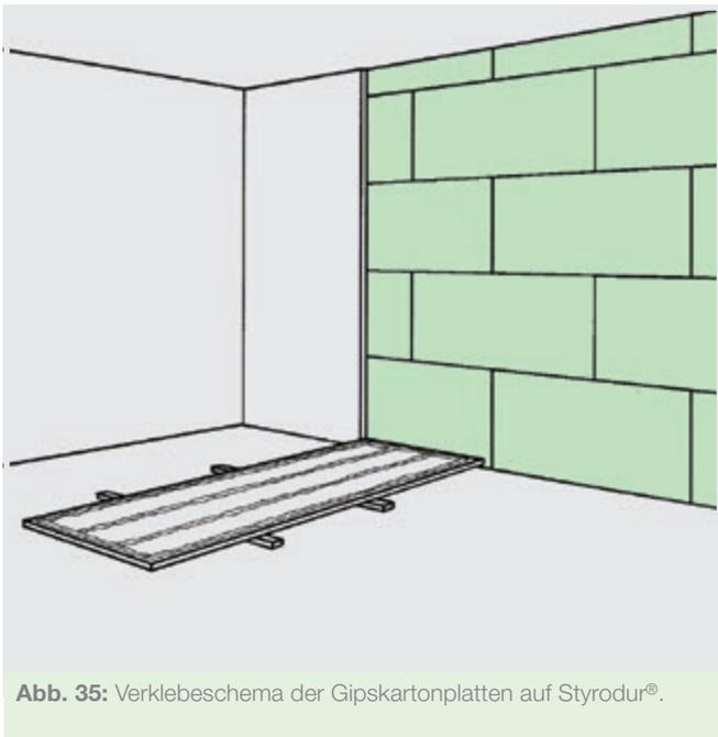
Abb. 35: Verklebeschema der Gipskartonplatten auf Styrodur®.
