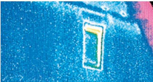
**Abb. 11:** Thermogramm der Wärmebrücke im Deckenauflegerbereich.
