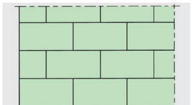
Abb. 9: Schema der Styrodur®-Plattenverlegung im Verband mit versetzten Fugen. Kreuzfugen sind zu vermeiden.
