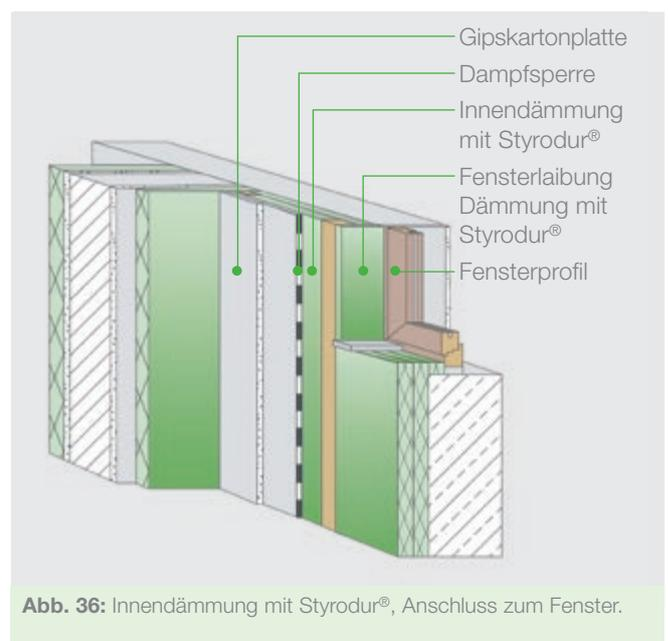
Abb. 36: Innendämmung mit Styrodur®, Anschluss zum Fenster.
