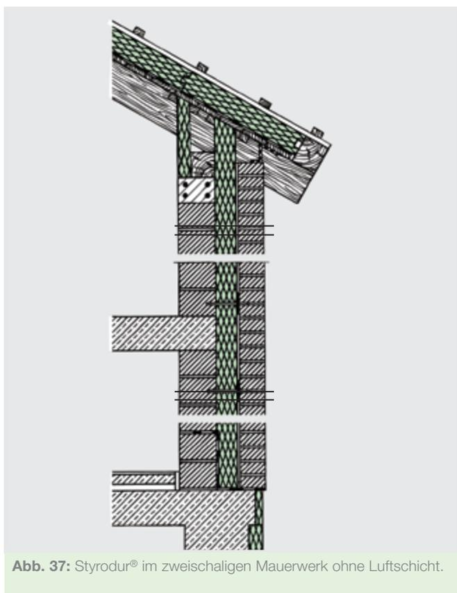
**Abb. 37:** Styrodur® im zweischaligen Mauerwerk ohne Luftschicht.
