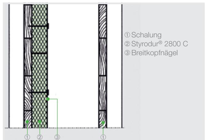
**Abb. 13:** Befestigen der Styrodur® 2800 C-Platten an der Holzschalung mit Breitkopfnägeln.
