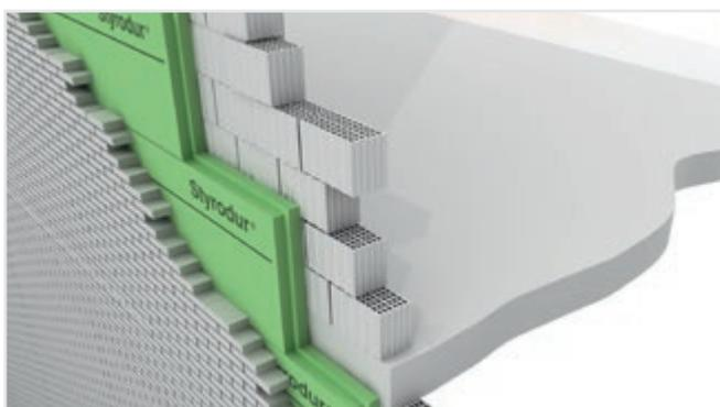
Zweischalige Mauerwerkskonstruktionen gehören in vielen gebieten Europas zur traditionellen Bauweise. Die geringe Wasseraufnahme, die guten Wärmedämmeigenschaften und die Langlebigkeit von Styrodur® erlauben den Einbau zwischen den beiden Wandschalen auch ohne Luftschicht.
