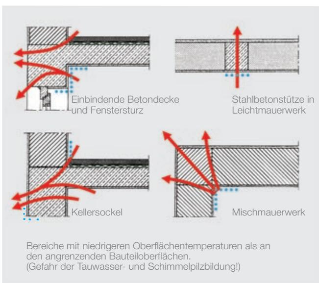
Abb. 4: Konstruktiv und stofflich bedingte Wärmebrücken.
