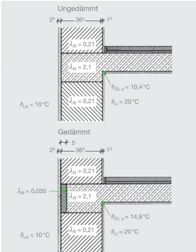
**Abb. 10:** Deckenaufleger mit Angabe der jeweiligen Innenoberflächentemperatur ohne und mit Wärmebrückendämmung mit Styrodur® 2800 C, Dicke 5 cm.
