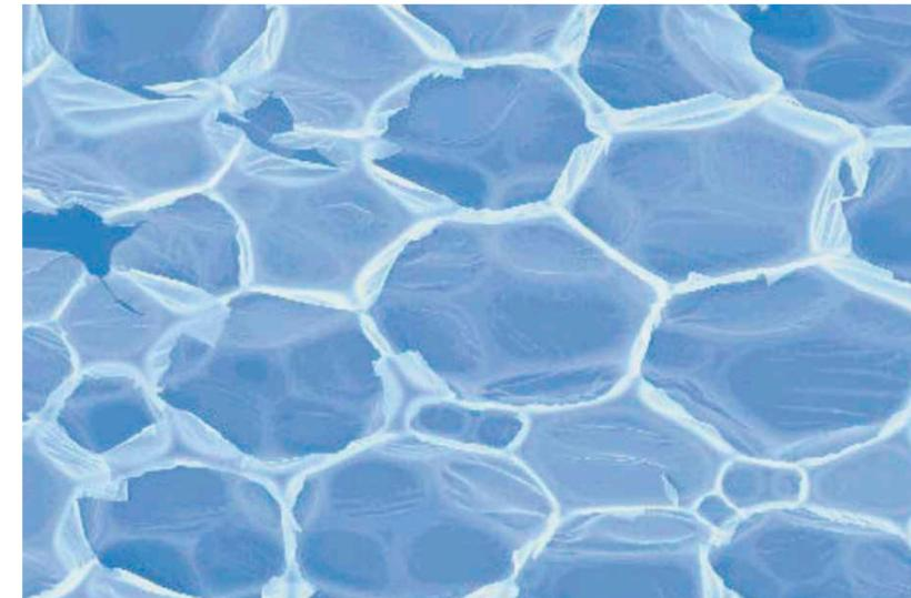
Das Volumen von Polyurethan-Hartschaum besteht nur zu einem geringen Teil aus festem Stoff. Bei einer bauüblichen Rohdichte von ca. 30 kg/m³ beträgt der Anteil des festen Kunststoffs nur etwa 3% des Volumens. Dieser bildet ein Gittergerüst aus Zellstegen und Zellwänden, um den mechanischen Belastungen Stand zu halten.
