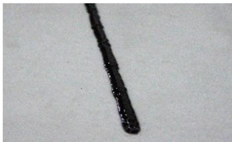
Der **Quellbandkleber für Bentonitquellbänder** ist nach dem Öffnen der Kartusche und dem Aufschrauben der, auf den passenden Durchmesser zugeschnittenen, Kartuschendüse verarbeitungsfähig.
