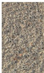
Viel verloren: Bis zu 1,0 kg/m<sup>2</sup> Masse darf nach DIN EN 1338 Klasse 3 der Masseverlust im Mittel betragen.
