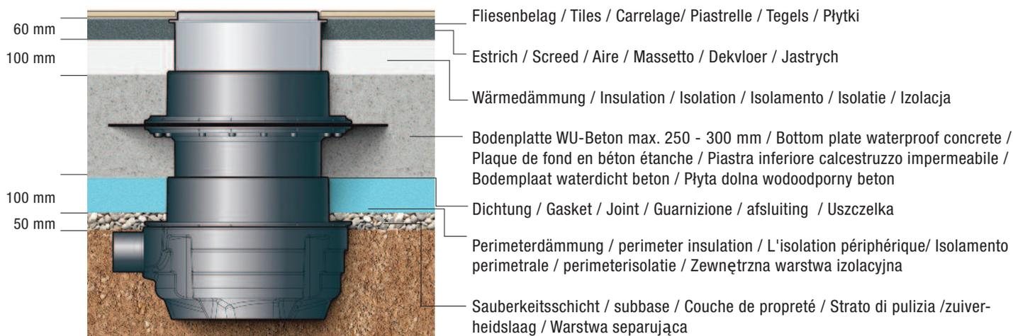
**Wärmedämmung unter der Bodenplatte (Perimeterdämmung) / Thermal insulation under the floor plate (perimeter insulation) / Isolation thermique sous la dalle (isolation périphérique)/ Isolamento termico sotto alla piastra di fondo (isolamento perimetrale) / warmteisolatie onder de bodem (perimeterisolatie) / Izolacja cieplna pod płytą podłogową (izolacja zewnętrzna)**
