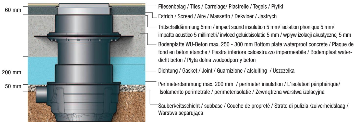
**Maximale Wärmedämmung über der Bodenplatte mit zusätzlicher Verlängerung / Maximum thermal insulation over the bottom plate with an additional extension / Isolation thermique maximale au dessus de la dalle avec rallonge / Isolamento termico massimo sopra alla piastra di fondo con prolunga aggiuntiva/ maximale warmteisolatie boven de bodem middels verlenging / Maksymalna izolacja cieplna nad płytą podłogową z dodatkową przedłużką (\*)**
