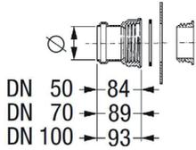
Art.-Nr. 39005, DN 50, Bohrung 60 mm
