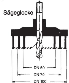
KESSEL-Säge Locke DN 50 - 150 (Best.-Nr. 50100)
