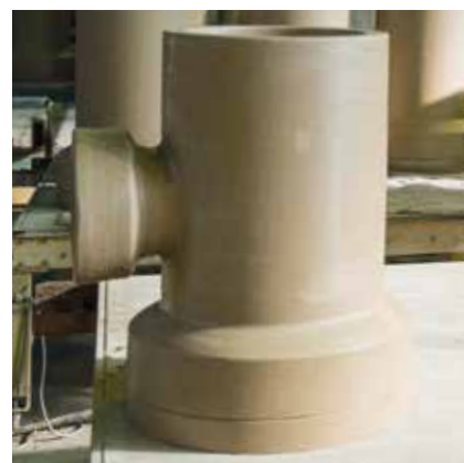
Fertigung: KeraBase Abzweig 90°
