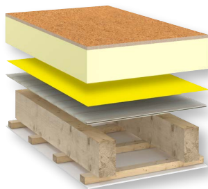
LINITHERM PHW LINITHERM PE Dampfbremse 120 Holzschalung Balken Raumseitige Bekleidung
