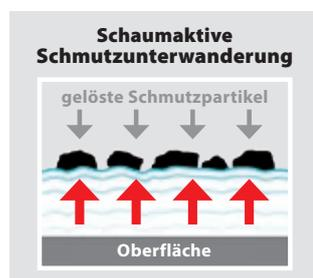
*Schaumaktive Wirkstoffe sorgen für eine sofortige Schmutzunterwanderung und garantieren maximale Reinigungsergebnisse bei geringstem Arbeits- und Zeitaufwand.*
